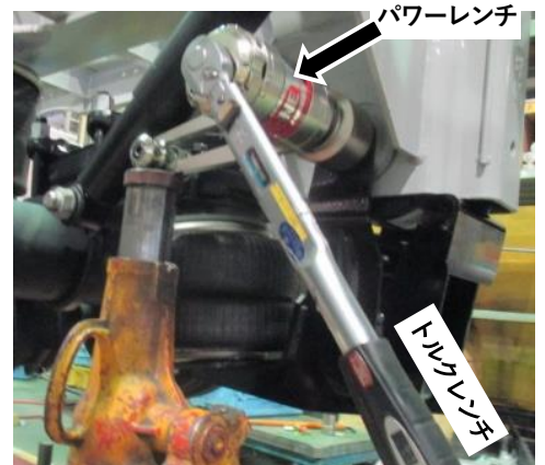
図3 パワーレンチ及びトルクレンチを使用した 締め付け
