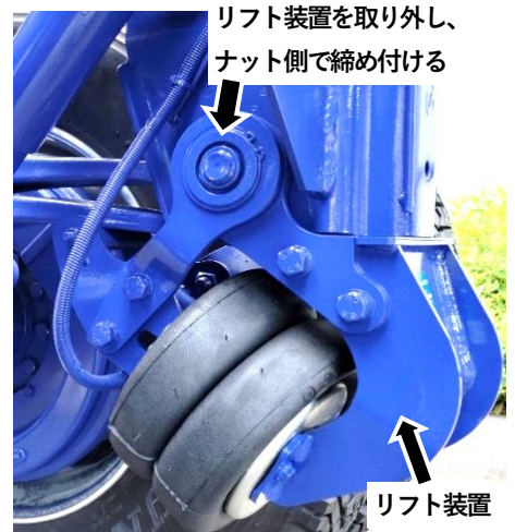
図4 リフト装置装着部も締め付け (車両内側より見る)
