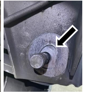
図2 ピボットボルト・ナットの 締付不良の例（ピボット ボルト用孔の摩耗）
