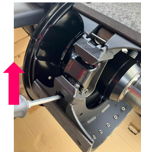
ドライバーを奥まで差し込み スプリングクランプの穴に 先端を差し込み、上に引き上 げる
