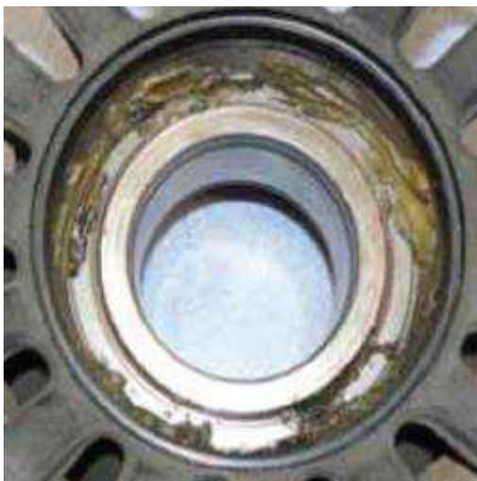
NG : オイルシールの全周に グリスが染み出ている
