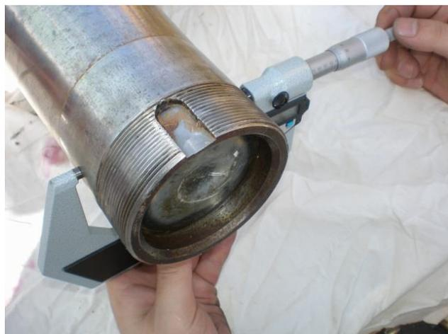
写真2 アウタ・ベアリング挿入部直径計測(水平方向)
