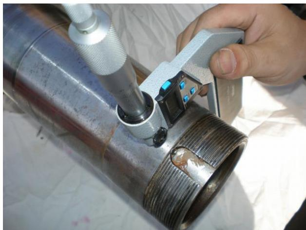
写真3 アウタ・ベアリング挿入部直径計測(垂直方向)
