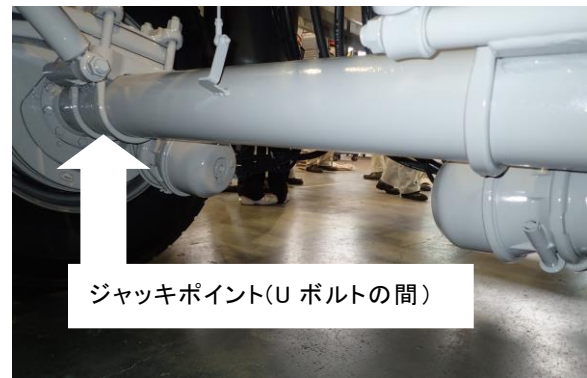
第6図. 車軸のジャッキアップ
