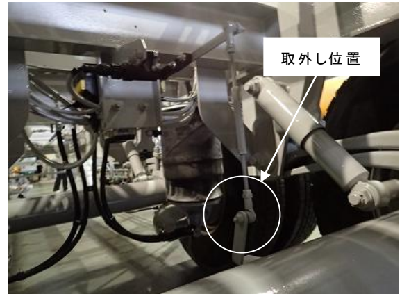
第4図．ハイト・センサロッドの取外し位置
