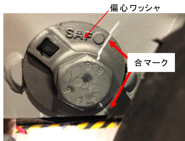
第3図. ピボット・ボルト部マーキング
