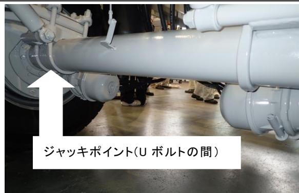
第6図. 車軸のジャッキアップ
