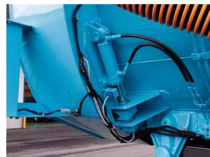
■油圧式テールゲートロック レシーバタンク後部に設置された2本の油圧シリンダにより、ゲートロックの開閉を行います。
