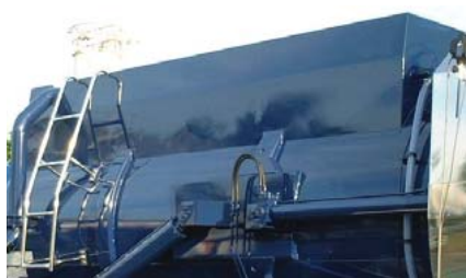
■レシーバタンク上部シェルタ レシーバタンク上部でのマンホール開閉作業などの安全性を向上します。
