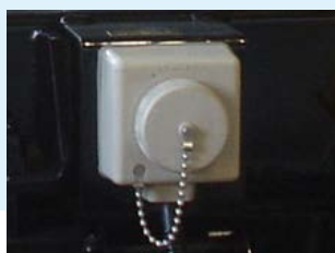
■コンセント(DC24V) 脱着式作業灯などの接続に便利です。
