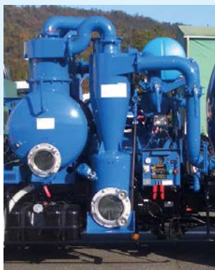
■サイクロン 増設により安心して粉体の吸引回収ができます。
