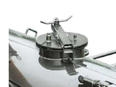
8 タンクマンホール
