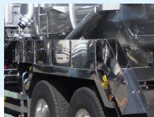
■樋型ホースハンガ ホースの積み降ろしがラクに行えます。
