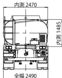
短尺型20KLタンクセミトレーラ
