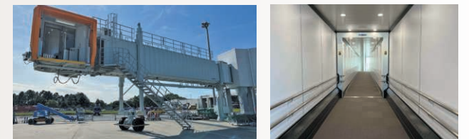
航空旅客搭乗橋「バリアフリータイプ(ガーターレス)」初号機(右は内部)
