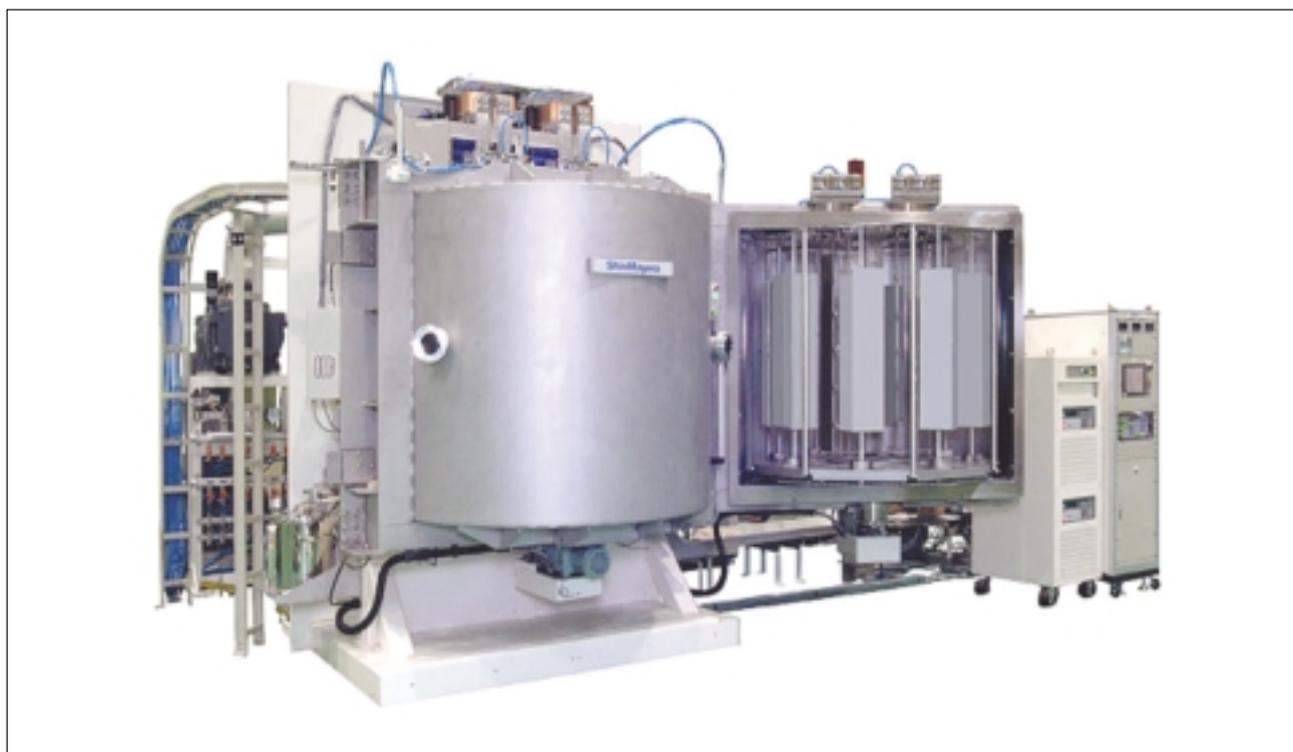
バッチ式蒸着重合装置
