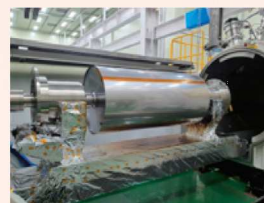
二次電池電極圧延用 DLCコーティングプレスロール DLC Coating Press roll for rechargeable battery
