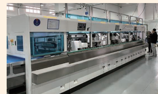
ASTグループと共同開発を進める同軸ケーブル加工機 (miniFAKRAコネクタ)
