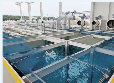
小野工場大型ポンプ運転検査設備 (ポンプ口径1200mmまで対応)
