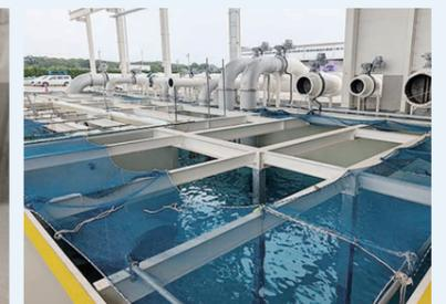
小野工場大型ポンプ運転検査設備
