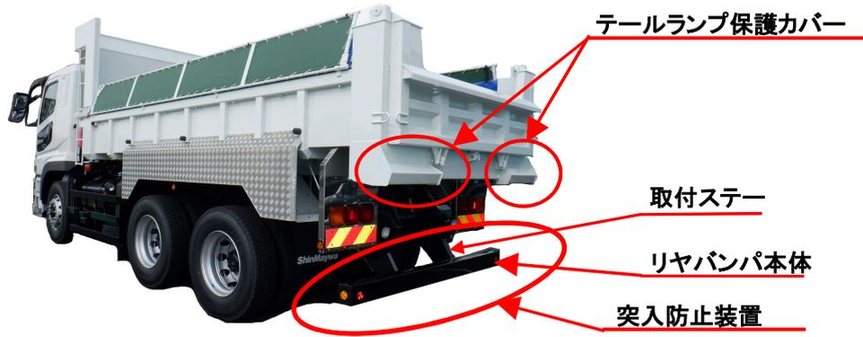
【突入防止装置のリヤバンパ本体と取付ステーの間にスペーサを取付ける場合】
