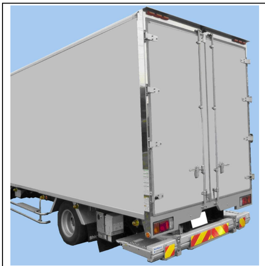
床下スライド格納式テールゲートリフタ (製品名：かくのうゲート)
