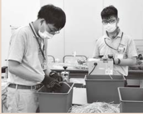
廃棄電線の処理業務。電線の被覆を剥き、中の銅線を取り出す
