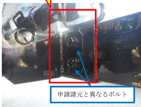
申請諸元と異なるボルト取付け 【改善前】
