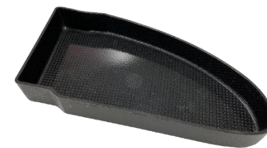
リサイクルCFRPを使った 航空機部品を模した成型品
