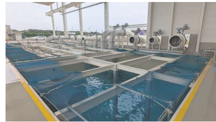
小野工場大型ポンプ運転検査設備 (ポンプ口径1200mmまで対応)
