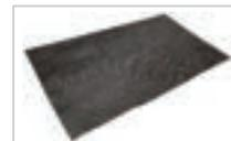
富士加飾の技術で再生したCFRP(繊維が整った状態)
