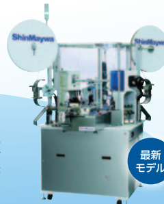
▲両端端子打機「TRD510」1本の加工にかかる時間は最速でわずか0.72秒!
