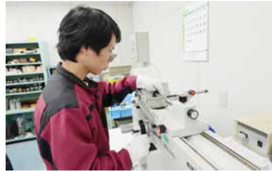
万能測長機を使用した測定器検査
