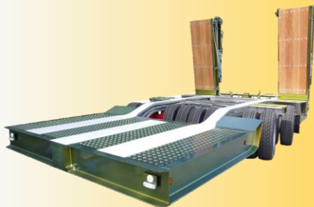
16輪ステアリング重トレーラ（参考出品） 2-axle 16-wheel steering axle drop bed semi trailer
