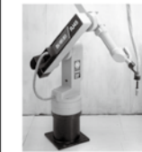
溶接ロボット
